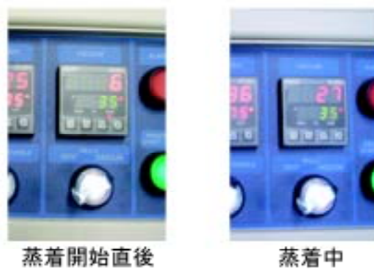
図14 蒸着しているかの確認は圧力を見て確認する。左は蒸着開始直後。右は蒸着時のもの。
