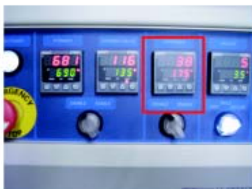
図 17 チャンバーを開ける前に VAPORIZER が 60 °C 以下であることを確認する。
